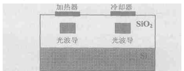
图7 设置冷却片的光开关截面结构
