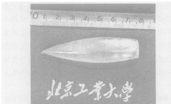
图 1 提拉法生长的  $\text{BaWO}_4$  单晶
