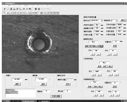
图 5 测量界面及捕捉到的补偿孔图像
