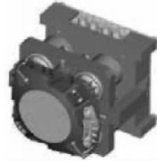
图7 音圈电机驱动快速反射镜
