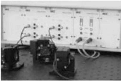
图5 德国 MRC Systems 公司的压电偏转工作台
