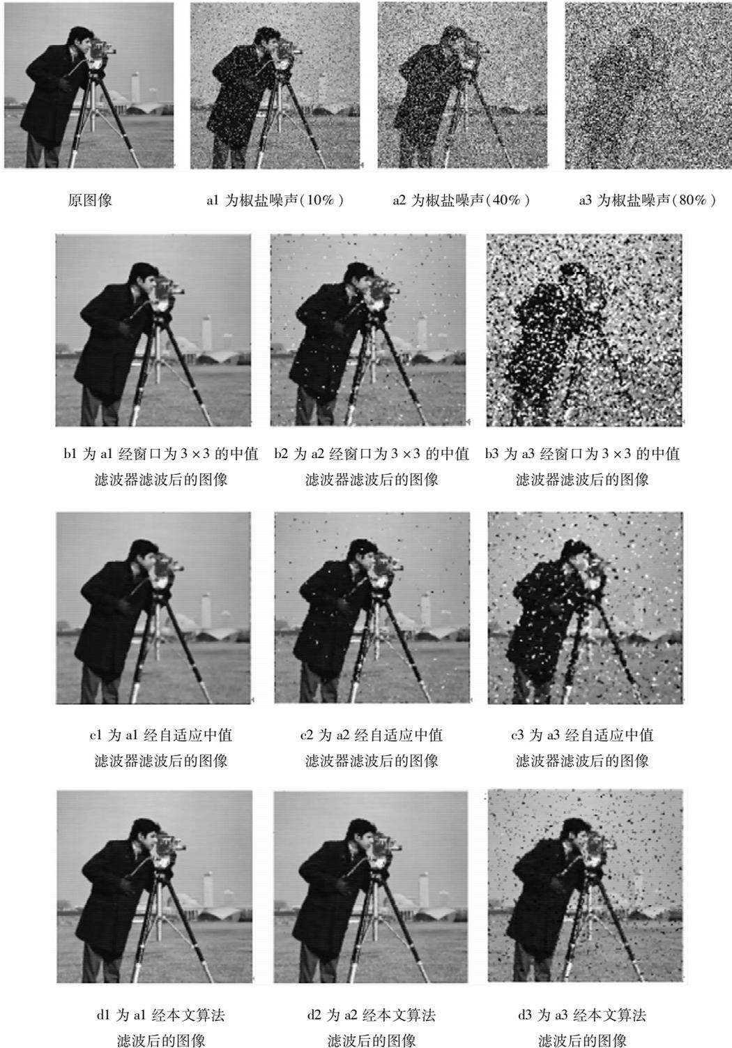
图2 不同程度噪声干扰下的 Cameramen 图像用不同的滤波器的滤波后图像
