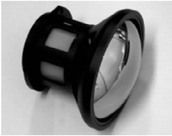
图3 加工完成的无热化镜头
