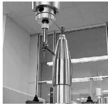
图 8 用于加工 Wolter I 型收集系统反射镜的心轴 [12]
