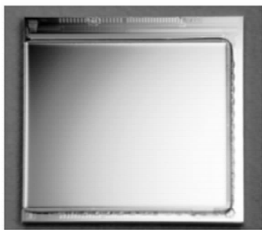
图5 背面减薄后的长波 640×512 量子阱焦平面探测器
