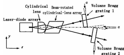
图 6 使用两个 VBGs 的外腔装置
