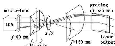
图 4 一个透镜可绕图中所示的轴旋转的外腔
