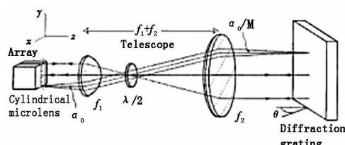
图 3 加了 1/2 玻片的外腔压缩系统
