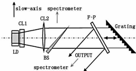
图 10 使用 F-P 标准具压缩泵浦光源线宽的外腔
