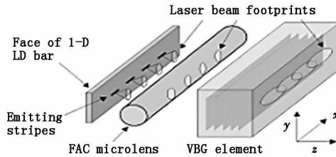
图 7 使用 VBG 压缩线宽另一种装置
