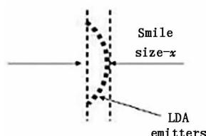
图 1 LDA 内发射极阵列分布示意图
