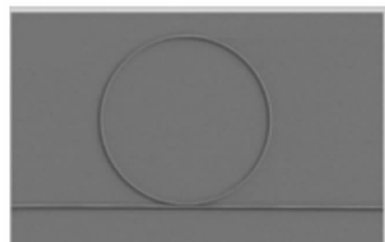
(b) 微环谐振器光学显微照片
