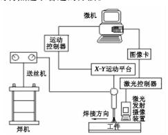
图 2 激光视觉焊缝跟踪示意图
