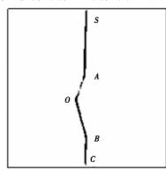
图 6 OTSU 法分割后的激光条纹图像
