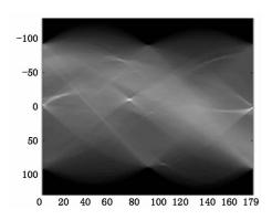
图 4 线结构激光焊缝图像 Radon 变换
