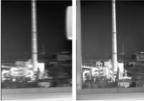
(a) 没有像移补偿的效果 (b) 有像移补偿的效果
