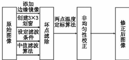
图1 图像处理算法设计流程
