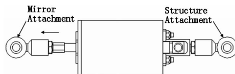
图7 VISTA 侧向支撑中推力作用机构
