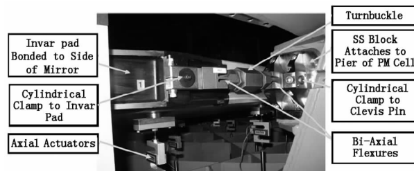
图9 SOAR 的侧支撑结构图
