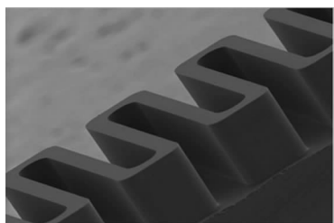
图 8 太赫兹微带型曲折线行波管的慢波结构示意图
