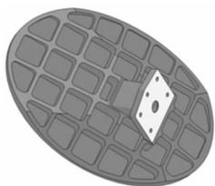
图6 轻量化反射镜三维结构图
