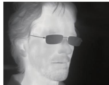
(b) 在APD反向偏压(50mV)下NUC后的热像
