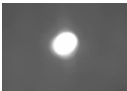
图4 266 nm 激光光斑图
