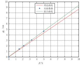
图 4 轴向拉力与 Bragg 波长漂移的关系
