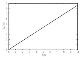
图 1 拉力变化量与光栅中心波长漂移关系
