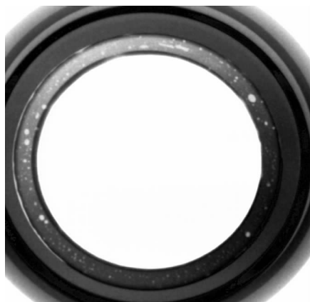
图2 金属化区域未作清洁处理的焊缝状态
