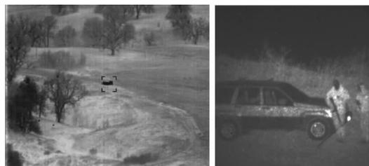
图 4  $2 \text{ km}$  公里远处的红外热图像(左)和 LIVAR 获取的目标识别图像(右)
