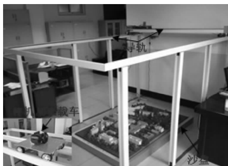
图8 三维地理数据采集实验平台
