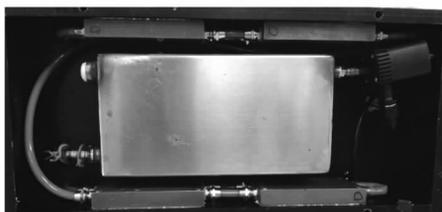
(b) 内循环水冷系统实物图
