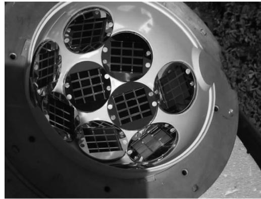
图 7 空腔式球体内部结构
