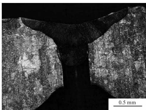
(a) 5 MPa 氦气下的焊缝熔深
