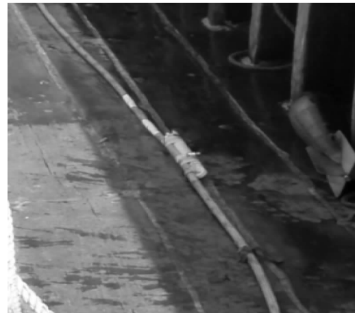
图 6 温度传感器与 SBE56 捆绑图
