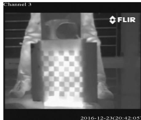
图 2 红外热像仪棋盘标定板图像
