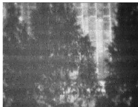
图5 小雨、薄积云天气情况下 0.05 ~ 1 km 处的目标红外图像
