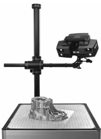
图2 GOM公司的ATOS系统 Fig. 2 ATOS system of GOM company
