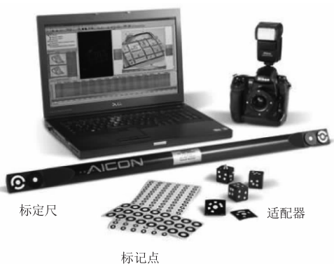
图3 AICON 3D公司的DPA-Pro系统 Fig. 3 DPA-Pro system of AICON 3D company
