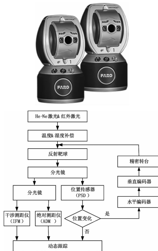
图1 FARO 公司激光跟踪仪及工作原理
