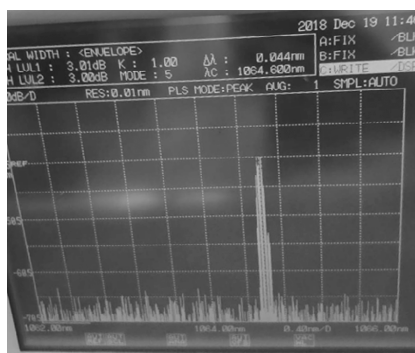
图 5 激光线宽光谱图
