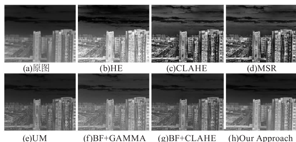
图 9 红外场景 3 测试 Fig. 9 Test infrared scene 3
