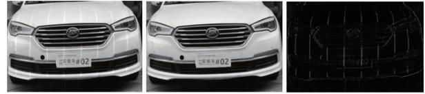
(a) 含光斑的A帧图像 (b) 不含光斑的B帧图像 (c) 含光斑的差分图像D
