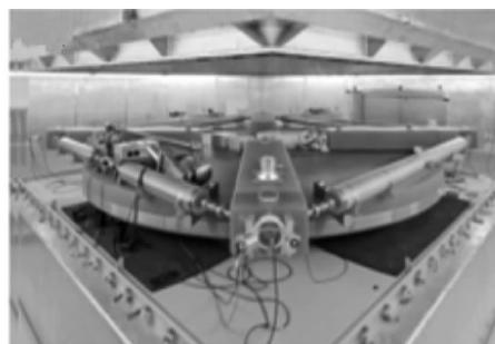
(a) G-ring大型激光陀螺仪的平面结构
