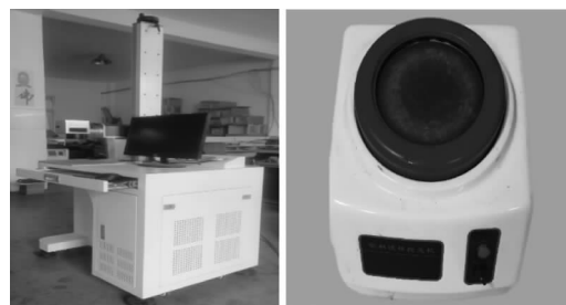
图 1 CETC26thPFL 脉冲光纤激光器设备和金相试样粗抛光机
