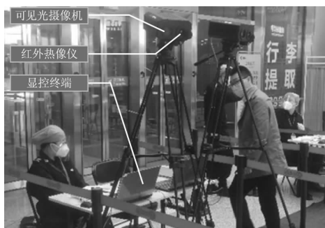
图5 红外测温筛查设备实际安装图
