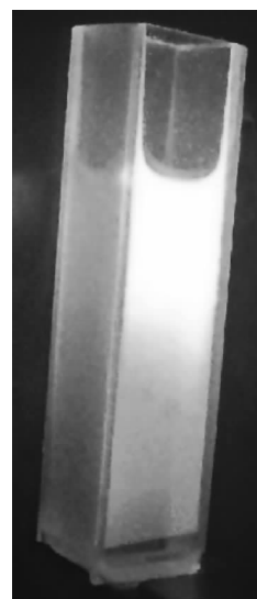
图1 激光诱导机油荧光效果图
