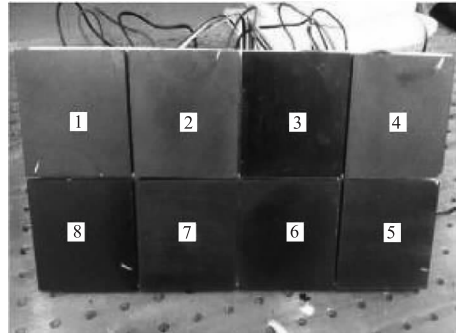
图 7 靶标敏感单元阵列实物图
