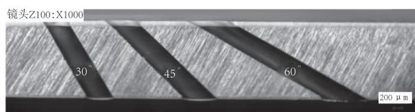
图7 带涂层高温合金斜孔制孔结果
