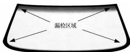
图2 汽车前挡风玻璃漏检区域
