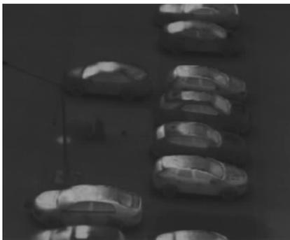
图 1 某停车场夜间车辆红外偏振图像
