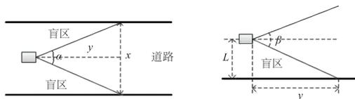
图5 红外车载驾驶员视区计算示意图
