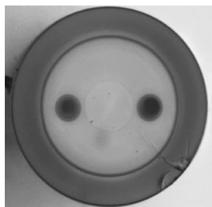
图8 高掺杂硅酸盐玻璃光纤横截面图
