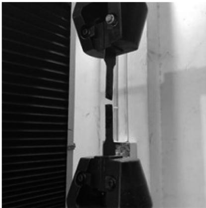
图 6 试件断裂图片
