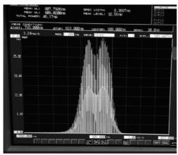
(d) 图 9 封装后的阵列光谱测试图
