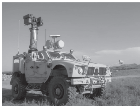
(a)车载移动式预警探测系统
