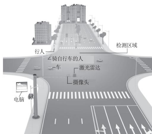
图7 路侧激光雷达点云信息采集系统
