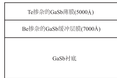
图 4 GaSb 衬底上生长 GaSb 薄膜的结构示意图
