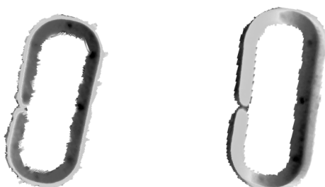
(a) 垂直拍摄不完全断裂点云
