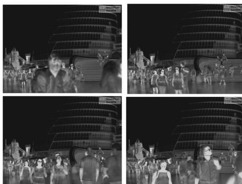
图 6 多尺度变比例、部分遮挡、部分形变目标跟踪
