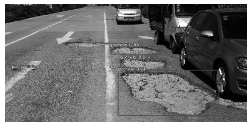
(a)YOLOv5s干燥道路测试效果
